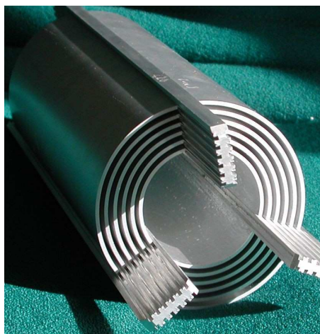
FIG. 3 – Assemblage du cœur du réacteur Jules Horowitz. Les plaques combustibles sont cintrées. Elles canalisent l'écoulement en leur sein. Les canaux ainsi formés sont annulaires.
