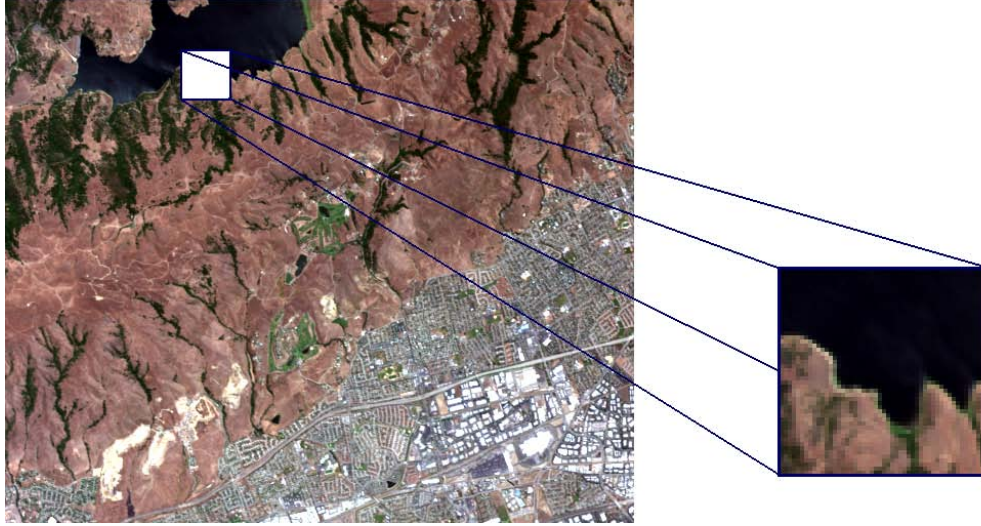
FIGURE 1.9 – Données hyperspectrales réelles : image de Moffett field acquise par AVIRIS en 1997 (à gauche) et la région d'intérêt représenté en couleurs réelles (à droite).
