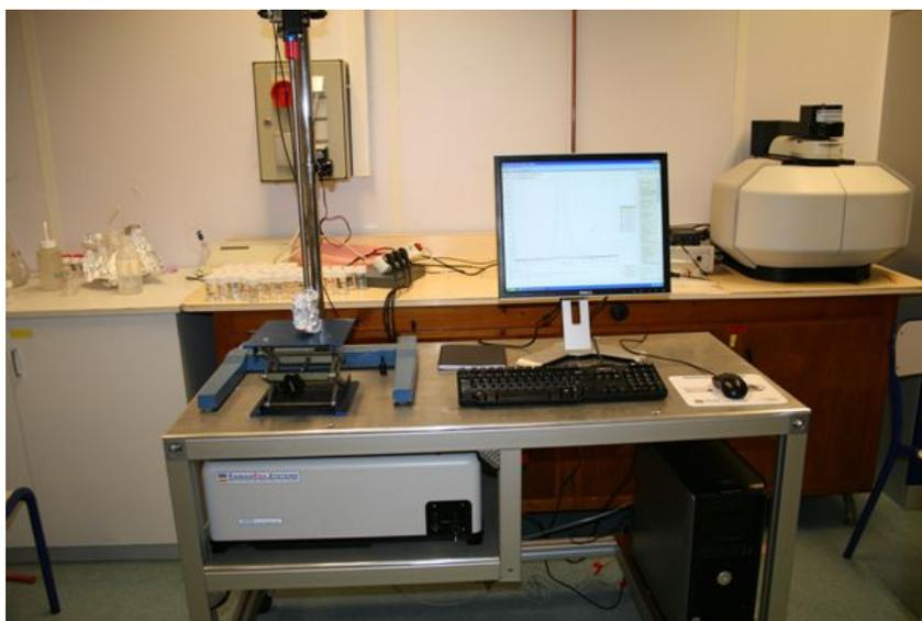
FIG. 2.31: Photographie du banc de spectrométrie Raman.
