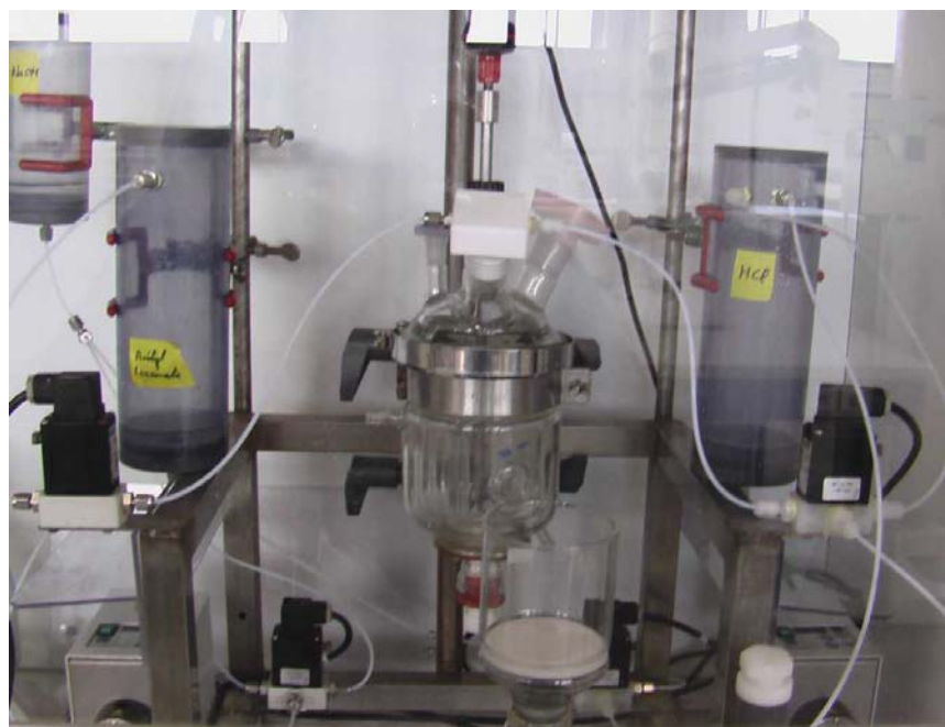
FIG. 5.3: Photographie du montage expérimental permettant la précipitation de l'acétyl-L-leucine à l'aide d'un mélangeur Hartridge - Roughton.
