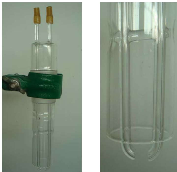
Photographie d'un mélangeur à jets impactants en verre
