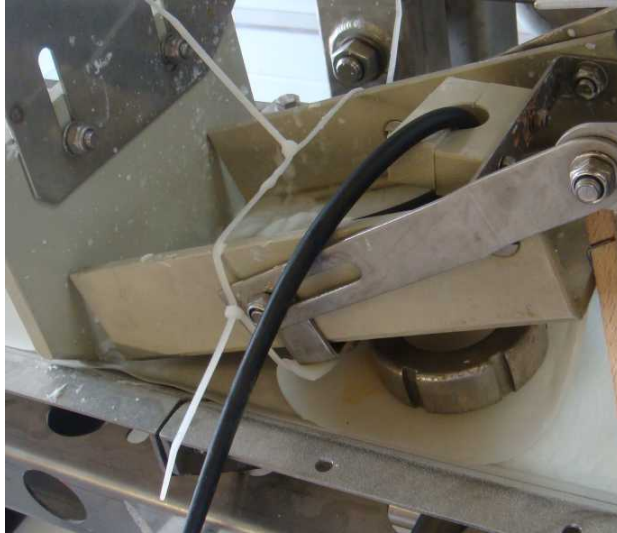
FIG. D.3: Photographie du dépôt de la suspension sur la bande du filtre.
