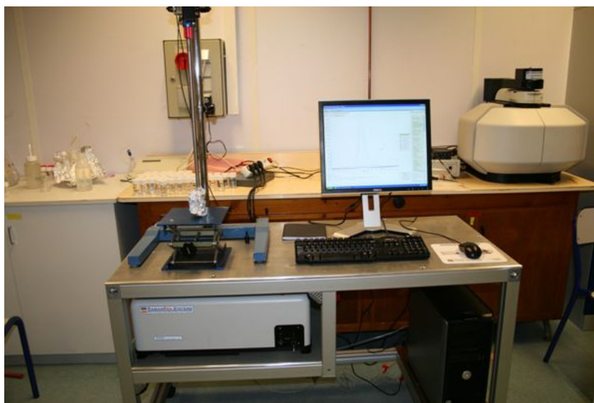
FIG. 2.31: Photographie du banc de spectrométrie Raman.
