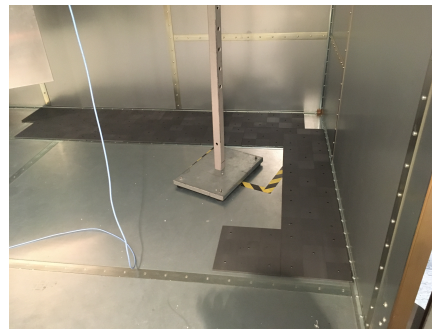
FIGURE 4.3 – Photos de l'EOLE 200 contenant 288 tuiles de ferrite.
