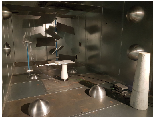
FIGURE 3.5 – Configuration chaotique de la CRBM de l'IETR.
