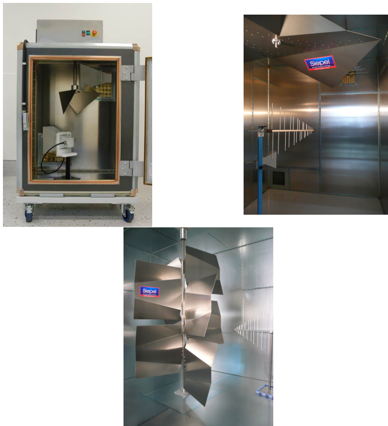
FIGURE 1.2 – Différents types de brasseurs mécaniques.
