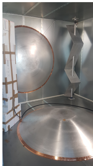
FIGURE 3.3 – Configuration chaotique de la CRBM de l'ESYCOM.
