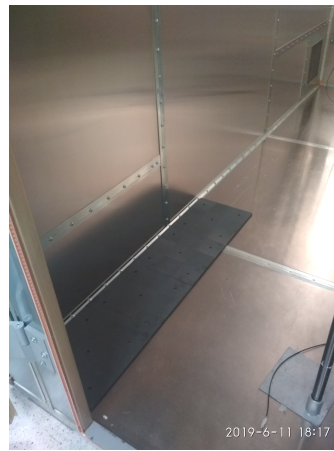
(b) CRBM contenant 36 tuiles de ferrite
