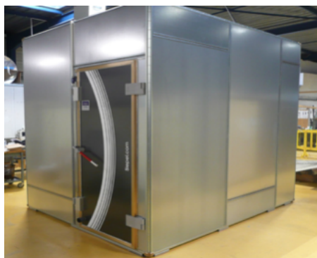
FIGURE 1.1 – Architecture extérieure type d'une CRBM.
