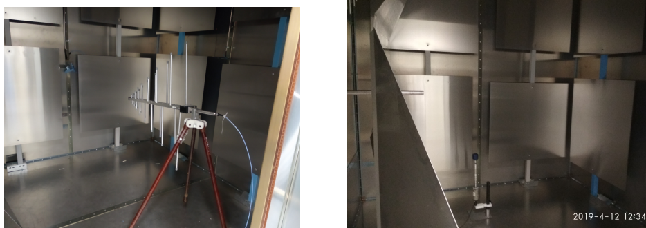
(a) Mesures préliminaires avec antenne de réception (b) Mesures avec sonde de champ isotropique
