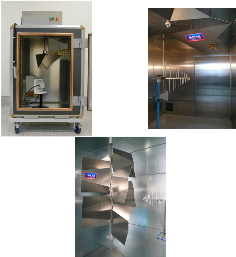
FIGURE 1.2 – Différents types de brasseurs mécaniques.
