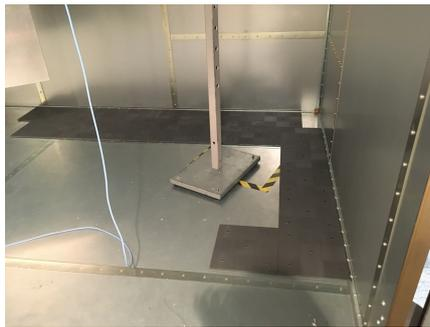
FIGURE 4.3 – Photos de l'EOLE 200 contenant 288 tuiles de ferrite.
