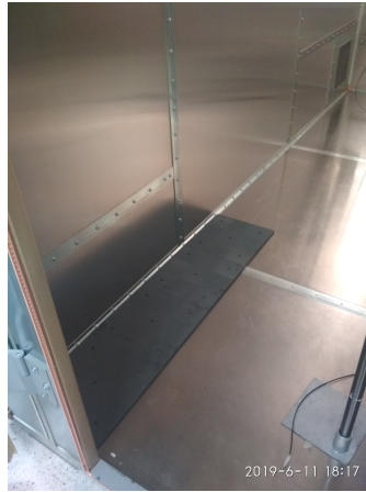
(b) CRBM contenant 36 tuiles de ferrite
