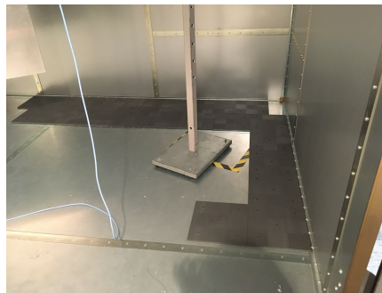
FIGURE 4.3 – Photos de l'EOLE 200 contenant 288 tuiles de ferrite.
