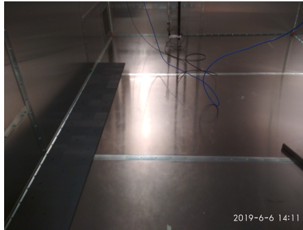
(c) CRBM contenant 72 tuiles de ferrite
