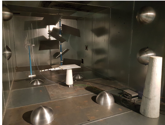
FIGURE 3.5 – Configuration chaotique de la CRBM de l'IETR.
