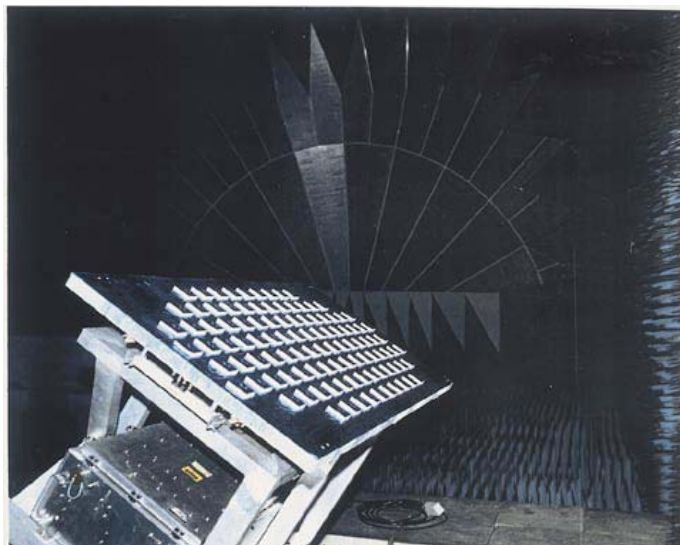
Figure 81 : Photo d'un réseau rayonnant sous test pour l'antenne active multifaisceaux émission/réception en bande L embarquée sur les satellites IRIDIUM [82]
