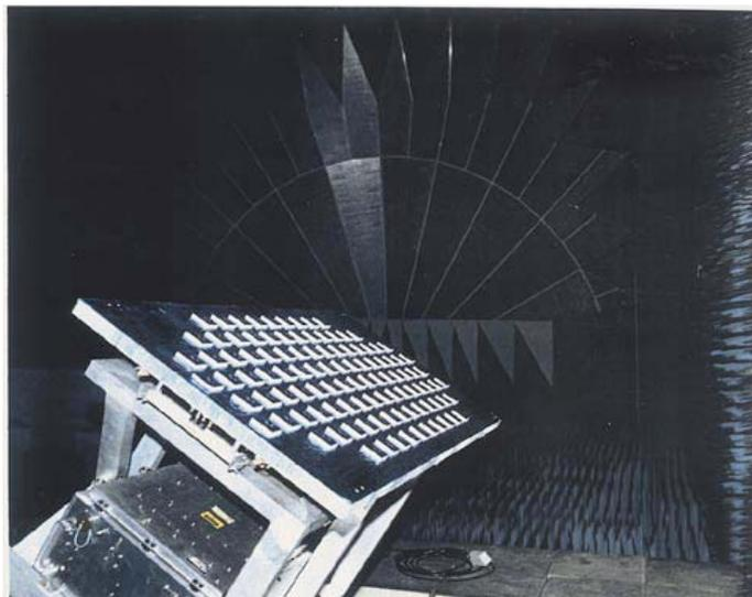
Figure 81 : Photo d'un réseau rayonnant sous test pour l'antenne active multifaisceaux émission/réception en bande L embarquée sur les satellites IRIDIUM [82]
