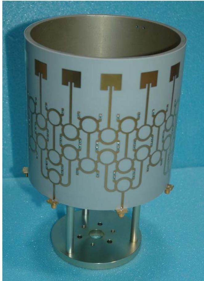
Figure 103 : Antenne réseau circulaire alimenté par un réseau périodique refermé
