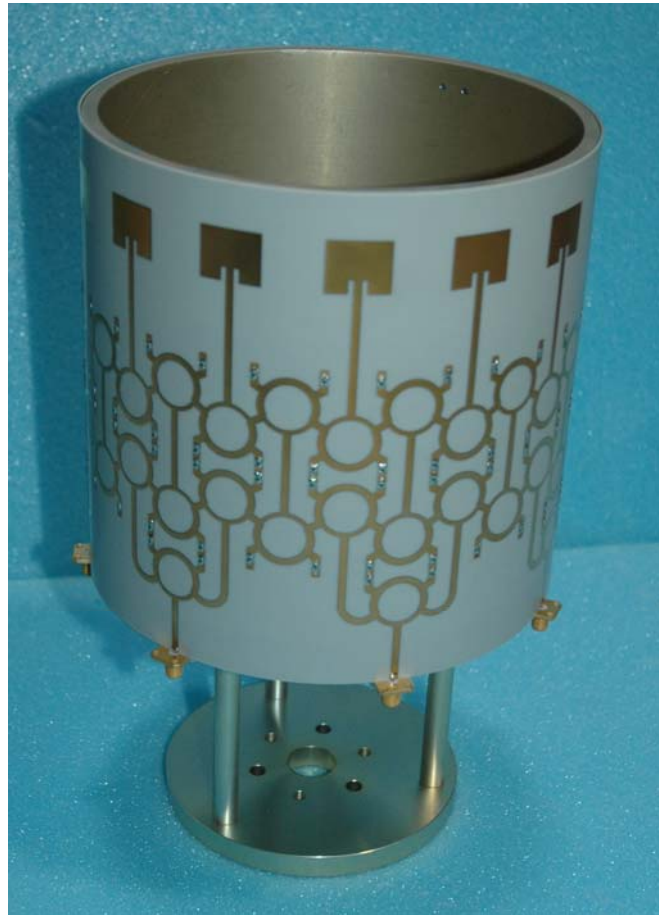
Figure 103 : Antenne réseau circulaire alimenté par un réseau périodique refermé
