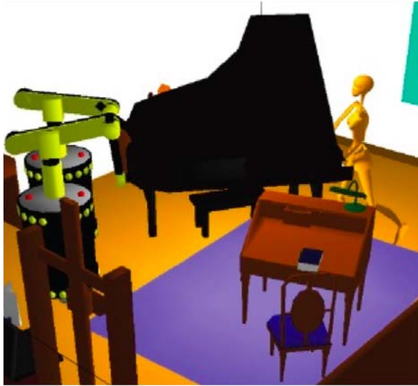
FIGURE 2.4 – Un exemple du problème du déménageur de piano. Un personnage virtuel et deux robots transportent un piano d'un côté à l'autre de la pièce en évitant les obstacles. Le système créé contient trois chaînes cinématiques fermées [Esteves 06].
