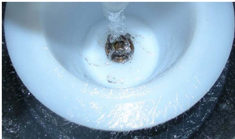
Figure A.5: Visualisation de l'épaisseur du film et de l'accélération du fluide par l'hélice dans un bol lisse sans zone de rétention (cônique sur toute sa longueur).
