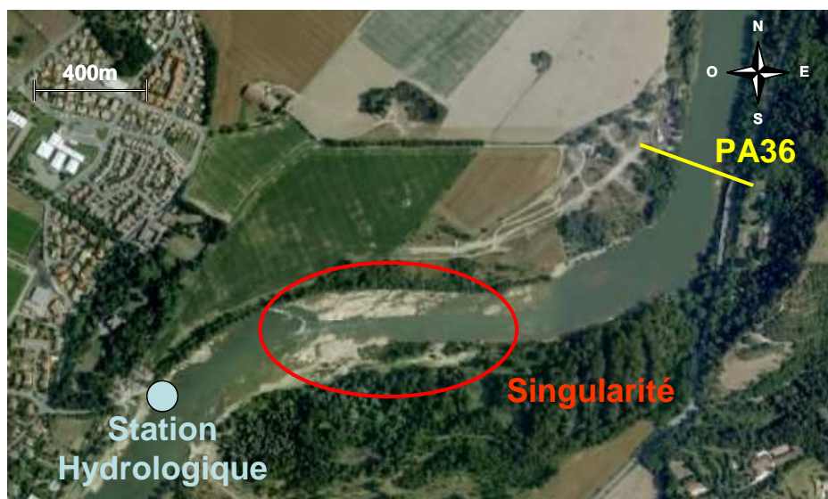
Figure 6.13 : Singularité entre la station hydrologique de Portet-sur-Garonne et le profil amont de notre tronçon (PA36)
