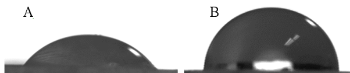
Figure 4.12 – Image d'une goutte posée sur un comprimé de talc F1 non enrobé (A) et de talc F1 enrobé avec 5 % de silice hydrophobe
