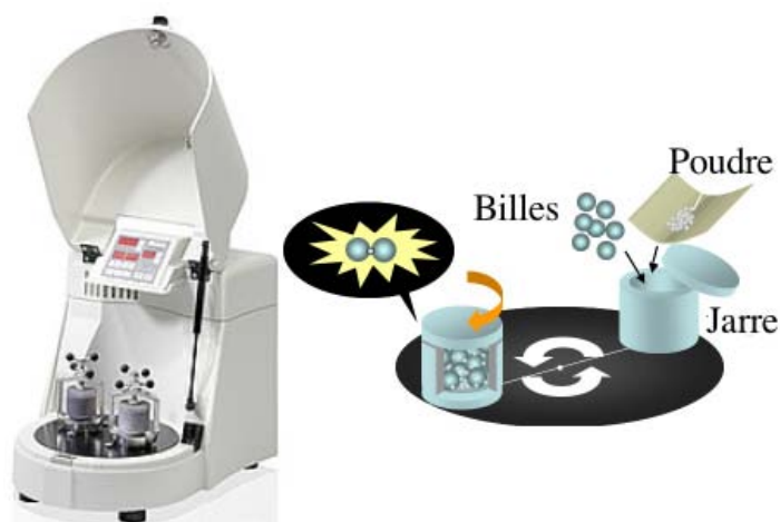
Figure 3.3 – Photographie (à gauche) et représentation schématique (à droite) du broyeur à billes planétaire
