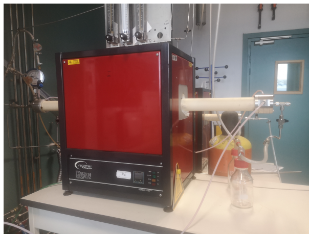
Figure 2.8 – Four à tube (alumine) environnemental utilisé pour les traitements thermiques à pression atmosphérique jusqu'à 1400 °C.
