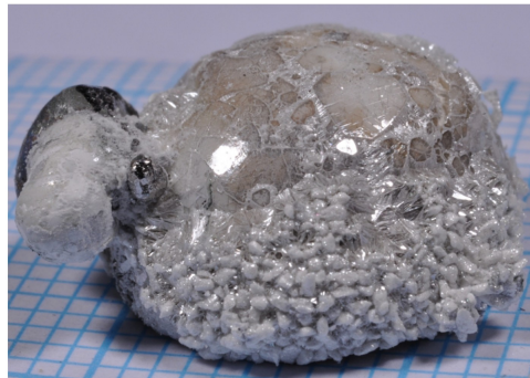
Figure 1.10 – Lingot de Ni-Cr solidifié et recouvert de hBN (transparent et brillant) après synthèse APHT. Reproduit à partir de [112].
