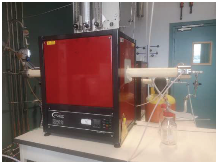
Figure 2.8 – Four à tube (alumine) environnemental utilisé pour les traitements thermiques à pression atmosphérique jusqu'à 1400 °C.
