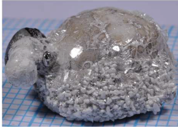
Figure 1.10 – Lingot de Ni-Cr solidifié et recouvert de hBN (transparent et brillant) après synthèse APHT. Reproduit à partir de [114].
