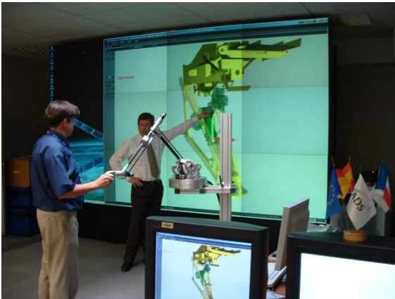
(a) Illustration d'évaluation et de formation au démontage de composants aéronautique dans le cadre du projet Samira (EADS)
