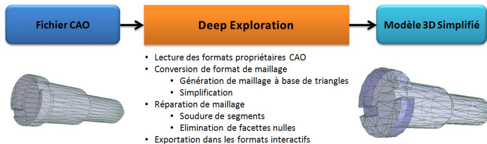
FIGURE 3.6 – Préparation hors ligne des modèles en vue de leur utilisation dans une scène virtuelle
