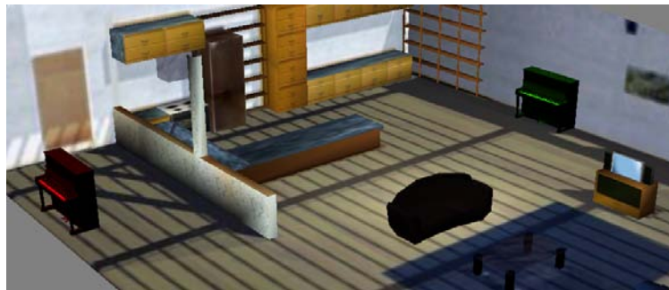
FIGURE 2.26 – Problème du "déménageur de piano" : trouver un mouvement sans collision entre une configuration initiale (verte) et une configuration finale (rouge) dans un espace encombré.
