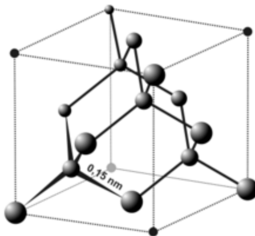
Figure I.17 : Structure cristalline du diamant
