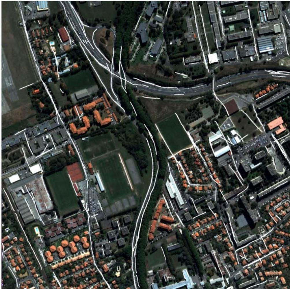
FIGURE 6.19 – Détection de routes - Scénario 2 - Exactitude=0.60 Complétude=0.58
