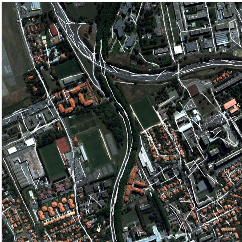
FIGURE 6.18 – Détection de routes - Scénario 1 - Exactitude=0.60 Complétude=0.69
