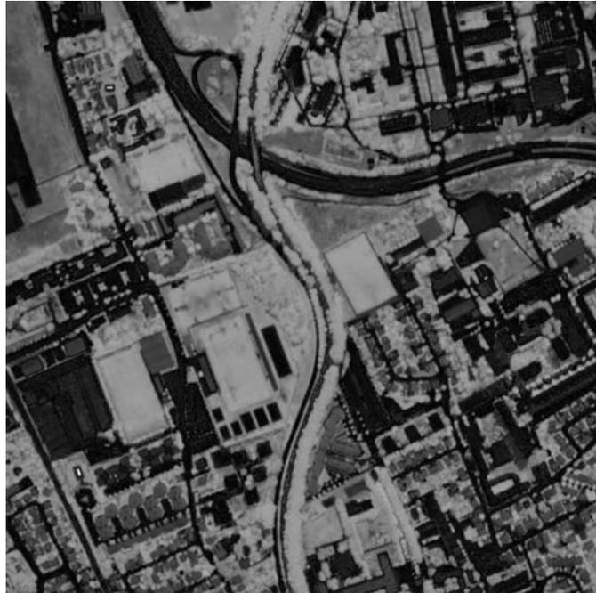
FIGURE 3.23 – Distance spectrale entre l'image 2.1 et la valeur spectrale de référence pour le matériau "asphalte"
