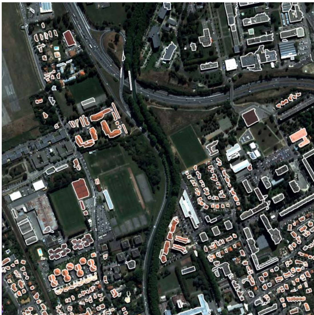
FIGURE 6.16 – Illustration des bâtiments détectés automatiquement
