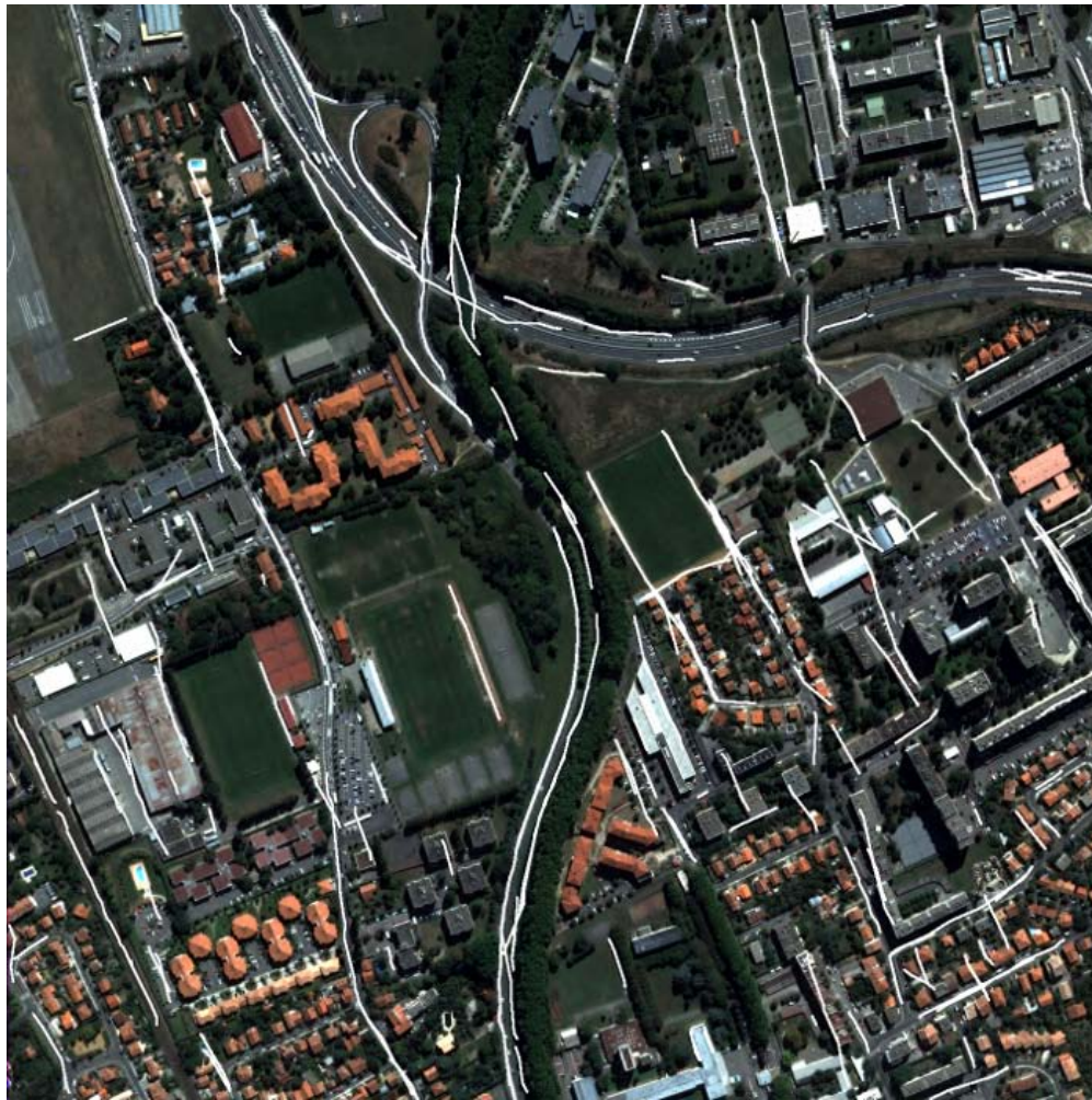
FIGURE 6.19 – Détection de routes - Scénario 2 - Exactitude=0.60 Complétude=0.58
