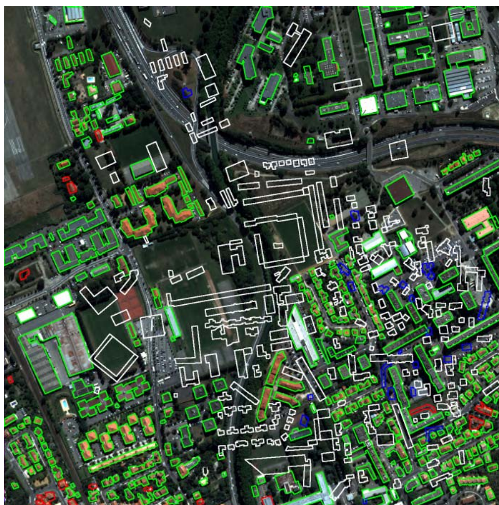
FIGURE 6.6 – Exemple de résultat de vérification de la BD bâtiments pour le scénario 1
