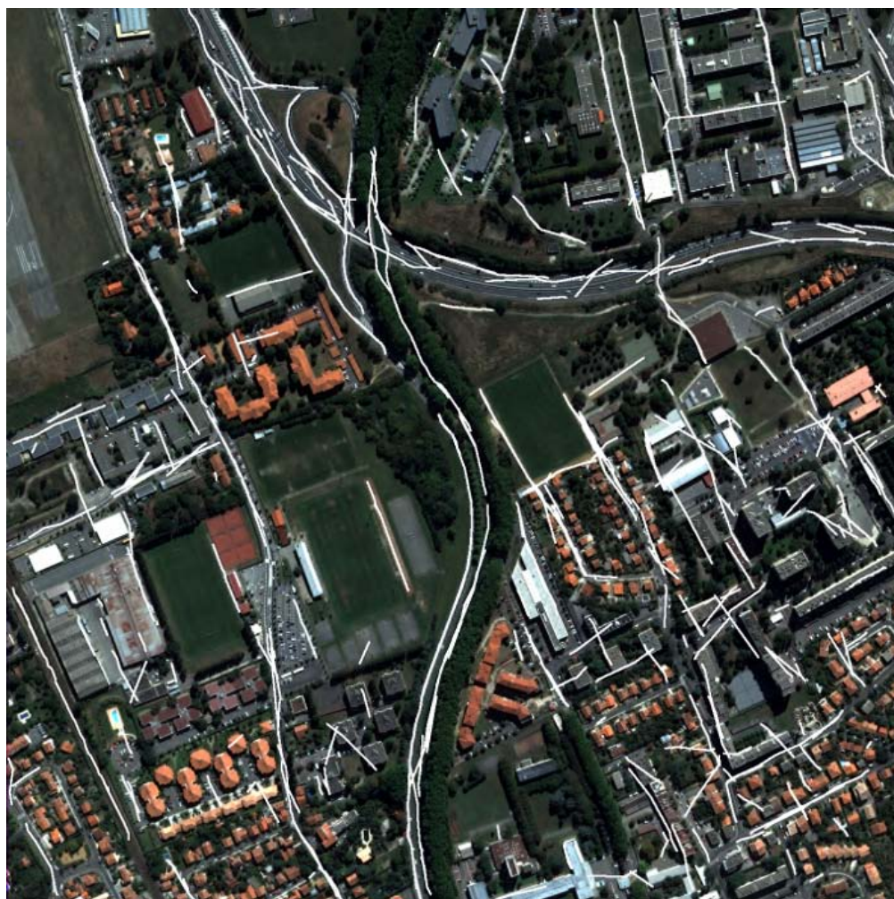
FIGURE 6.18 – Détection de routes - Scénario 1 - Exactitude=0.60 Complétude=0.69
