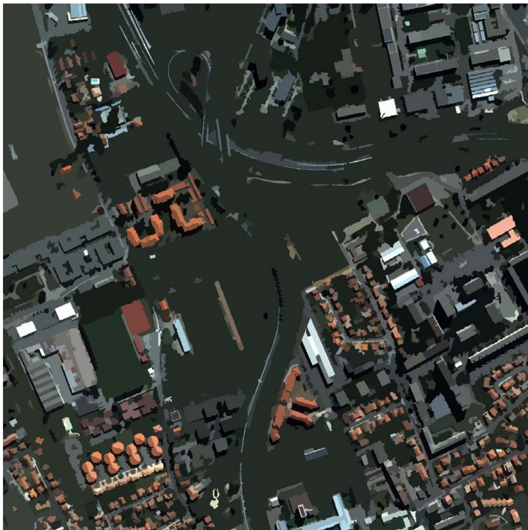
FIGURE 3.8 – Segmentation avec un rayon spectral de 40
