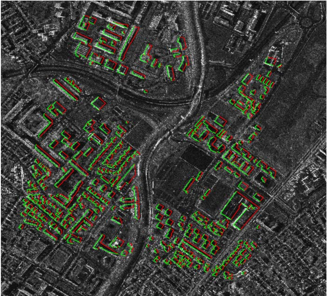
FIGURE 3.22 – Bâtiments projetés sur l'image RSO
