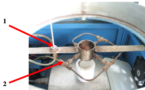
Figure II.5. Entrées d'azote dans le four Aubry : 1 – sole du four, 2 – tige de la balance
