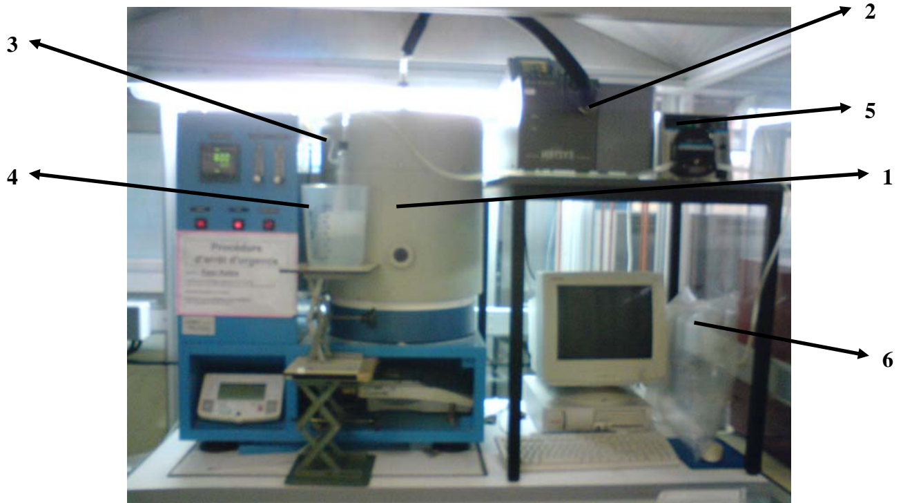
Figure II.7. Four Aubry modifié et ses unités auxiliaires pour la gazéification à la vapeur d'eau : 1 – four Aubry modifié, 2 - générateur de gaz humide, 3 – tube laveur, 4 – bain de glace, 5- pompe péristaltique, 6 – sachet prélèvement des gaz en Tedlar
