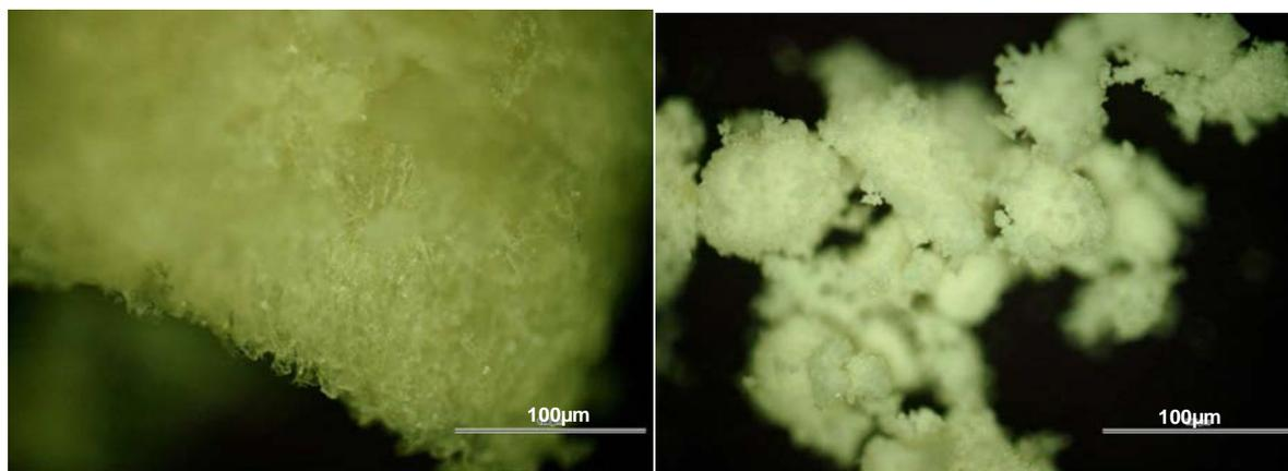
**Figure 23** : Observations microscopiques x 400 avec la lumière polarisée des émulsions séchées obtenues par lyophilisation (à gauche) et par atomisation (à droite). L'échelle représente 100 µm
