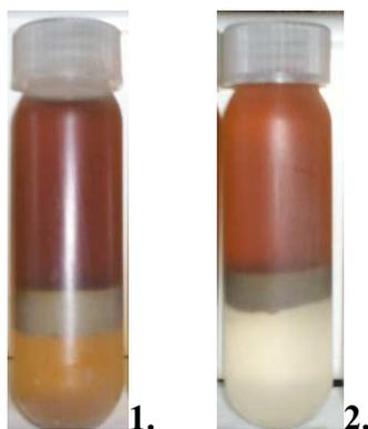
**Figure 13 :** Photographie montrant l'effet du sel dans la méthode de séparation triphasique avec le butan-1-ol sur une émulsion obtenue suite à un procédé intégré avec hydrolyse sur des graines de colza.
