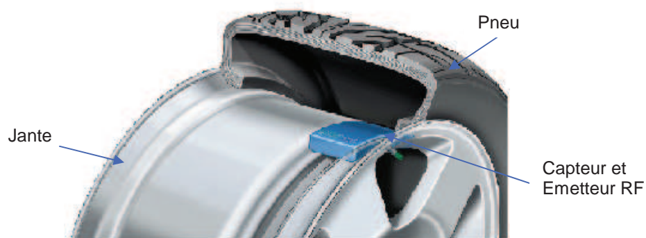
Figure.2.1: principaux éléments constructifs d'une source TPMS
