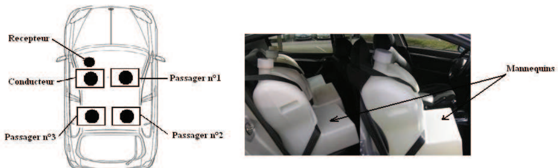
Figure.2.37 : procédure d'expérimentation de l'influence du nombre de personnes sur le canal de propagation TPMS
