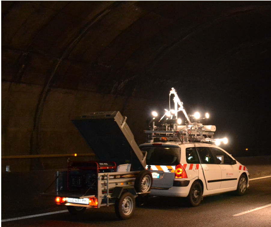
FIGURE 2.1 – Système d'acquisition utilisé dans le tunnel de Rive-de-Gier et monté sur un véhicule. Ce système comprend 4 caméras et 10 projecteurs. Un groupe électrogène assure l'alimentation de l'ensemble des équipements.
