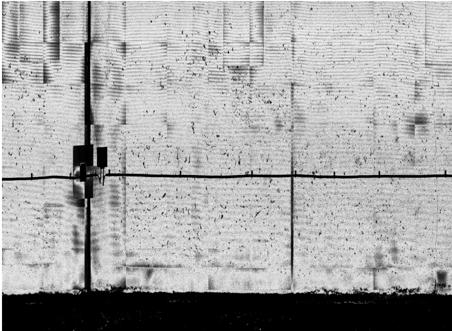
FIGURE 2.16 – Carte présentant les outliers issue de la régression robuste. Plus un pixel est sombre, moins il est pris en compte lors de la régression de la surface, et inversement.
