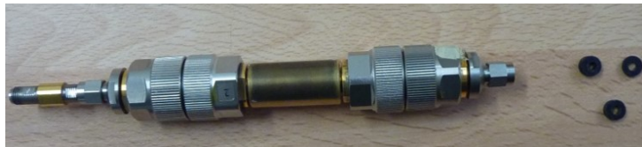
FIGURE 3.40 – Cellule coaxiale EpsiMu et échantillons d'ABS mesurés
