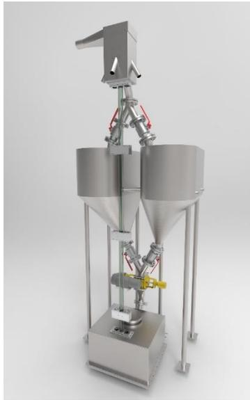
Figure 55 : Schéma en trois dimensions du banc expérimental RALF conçu pour une étude à température ambiante.
