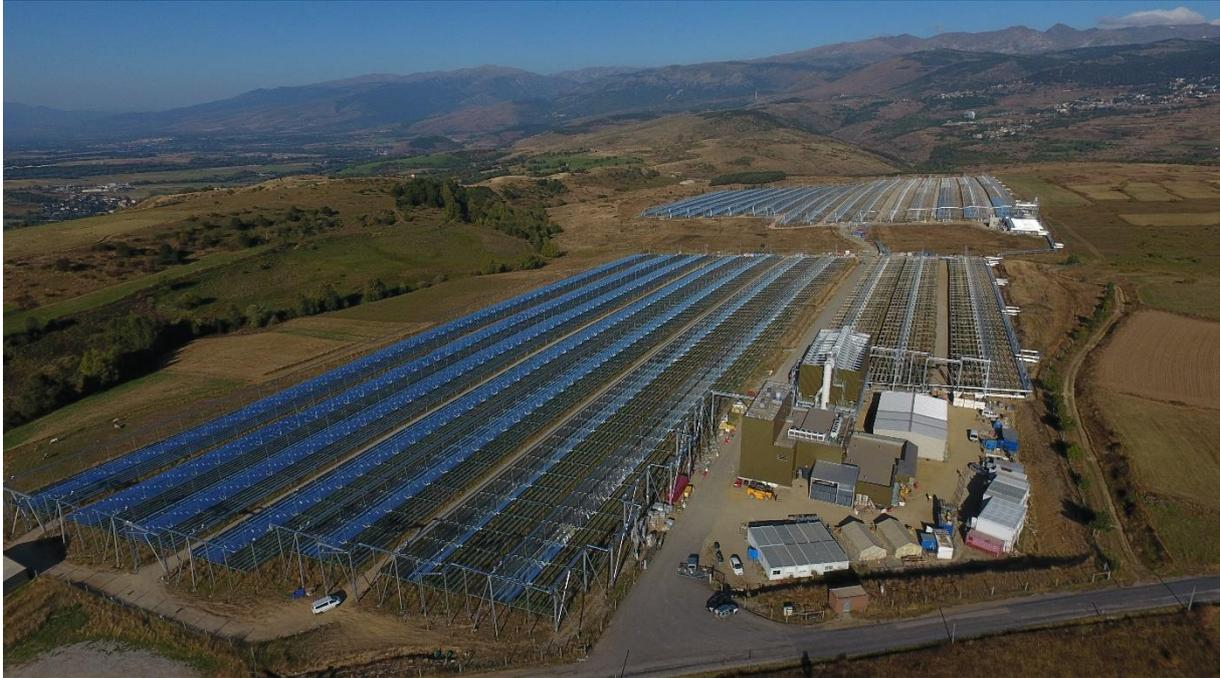
Figure 8 : Photo aérienne de la centrale Fresnel thermodynamique eLlo, dans les Pyrénées Orientales (France).
