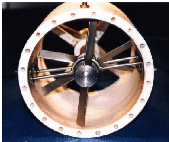
Figure III-4 : Photographie des couteaux granulateurs et des émotteurs à l'intérieur de la cuve en Téflon
