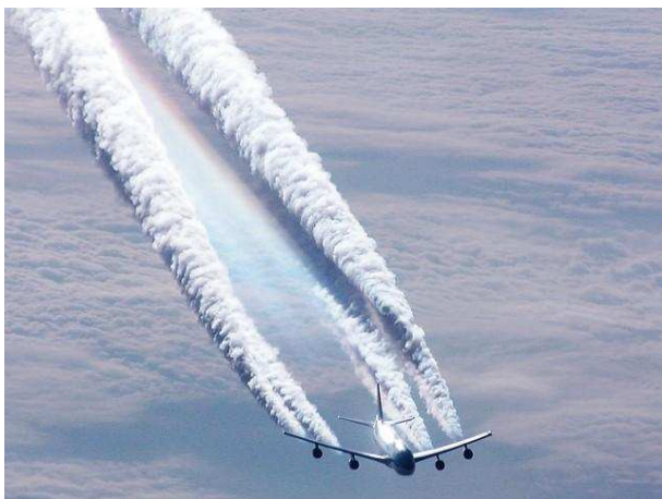
Figure 1.4 : Enroulement des jets et des cristaux de glace autour des deux tourbillons marginaux
