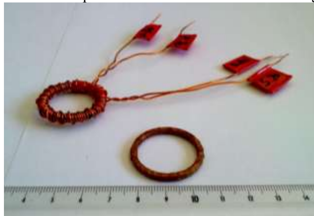
figure D.27 : schéma et dimensions du tore en acier.
