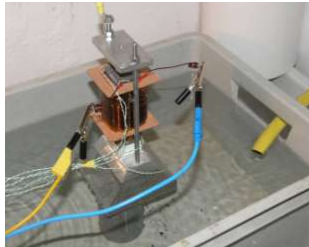
figure II.18 : dispositif de l'étude thermique pour les relevés en bout (Grem3 – Laplace – INPT/Enseeiht).
