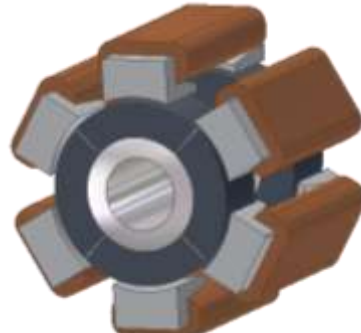
figure II.25 : vue schématique de la structure hétéropolaire.
