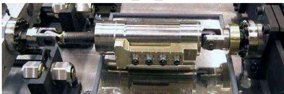
figure I-13 : schéma et photo d'un EMA direct drive [MEN-09].
