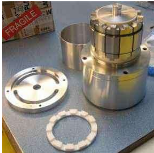
figure III.9 : photos d'un plot et du moule à résiner.
