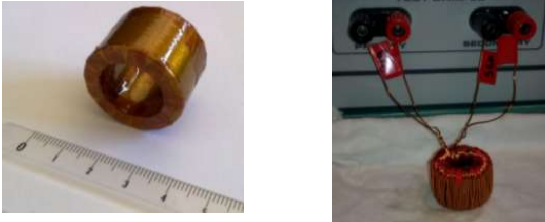
figure D.32 : échantillon magnétique en smc Somaloy700 usinée à l'électroérosion.
