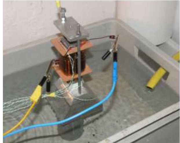
figure II.18 : dispositif de l'étude thermique pour les relevés en bout (Grem3 – Laplace – INPT/Enseeiht).
