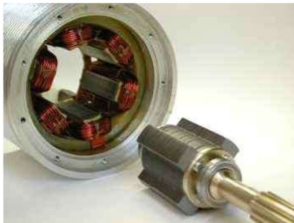
figure II.1 : Machine à réluctance variable 6:4 (grem3 – inpt/enseeiht).
