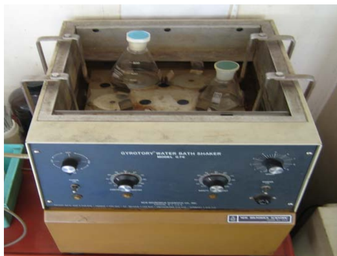
Figure II.5. Photographie de l'agitateur secoueur utilisé pour l'extraction batch
