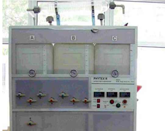
Figure II.7. a) Photo de l'extracteur rotatif (tableau de commande et réservoirs)
