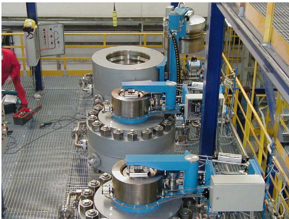
Figure I.12. Application industrielle pour l'extraction supercritique du houblon (Pologne)
