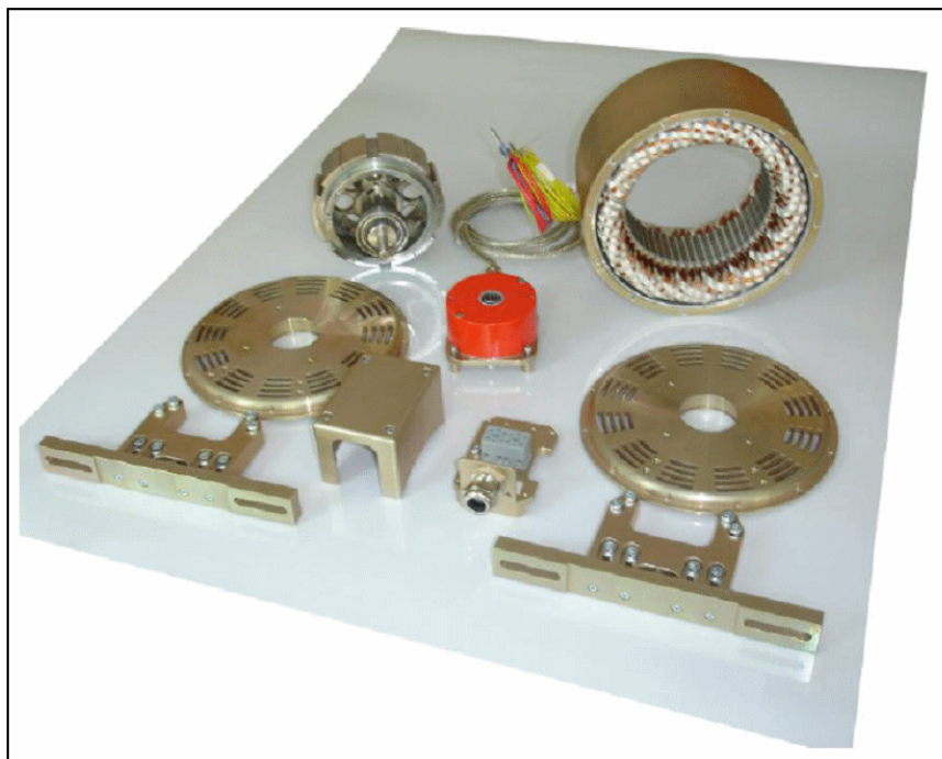
Fig.III. 14: Vue éclatée du prototype de génératrice
