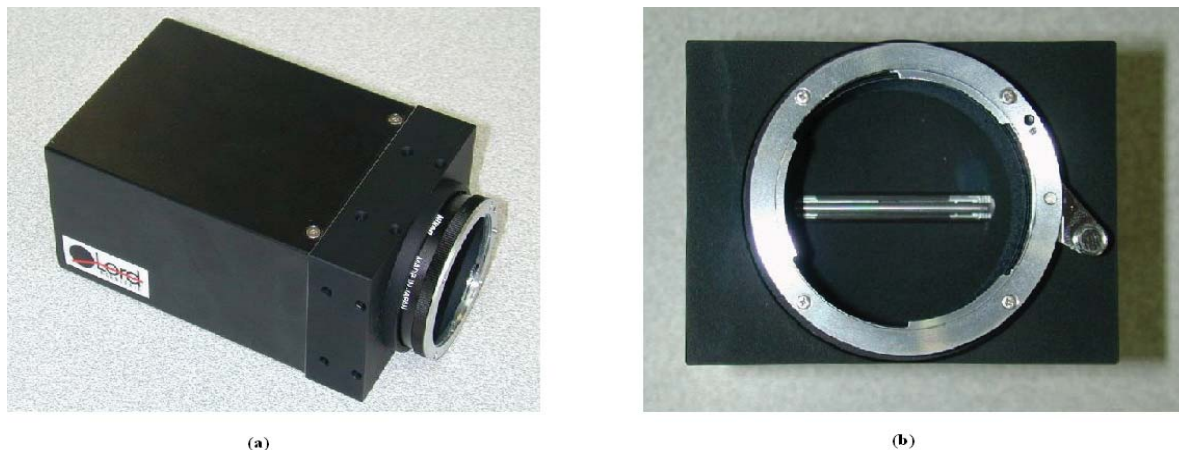
FIGURE 2.16 – (a) Caméra linéaire; (b) Capteur CCD de 5000 pixels
