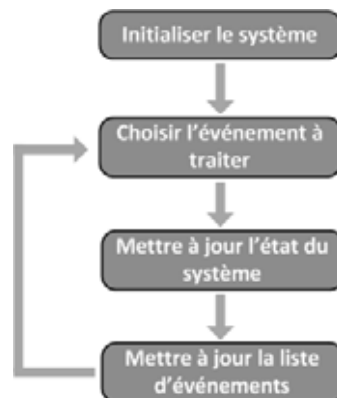
Figure 3.12: principe de fonctionnement d'un modèle à événements discrets
