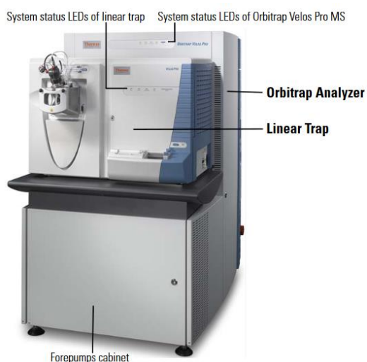
Figure 29: Photographie et spécifications du Thermo Orbitrap Velos Pro Orbitrap [75].
