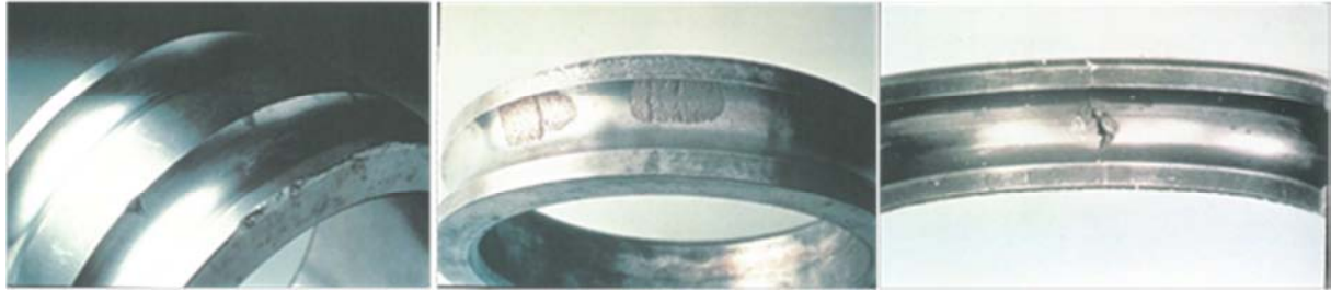
Figure 1-14 : Endommages physiques créés par le défaut de montage de roulements [42]
