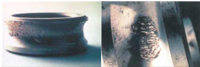
Figure 1-17 : dégradations dues à des surcharges mécaniques [42]
