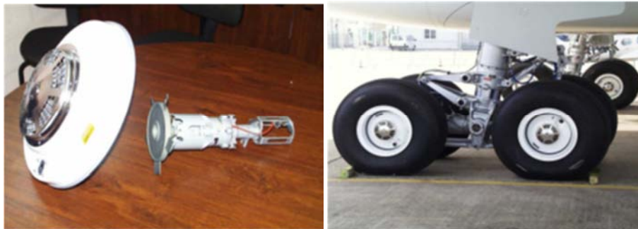
Figure 1-3 : Ventilateurs de refroidissement des freins [3]
