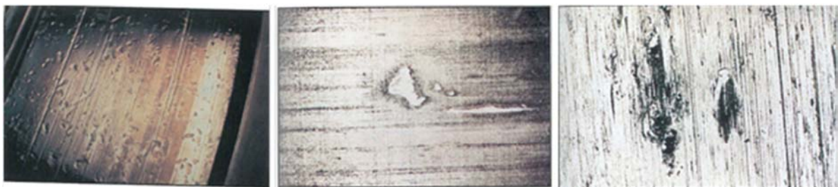
Figure 1-11 : Effets sur les pistes de roulements de contaminations du lubrifiant [42]
