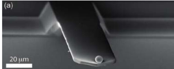
FIGURE 8: Levier avec pointe colloïde (Image par Microscope Electronique à Balayage issue du site ResearchGate).
