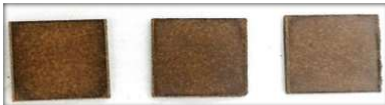
Figure IV-11 : Photos de plaques obtenues par thermopressage des raffinats du fractionnement des graines de neem en extrudeur bi-vis
