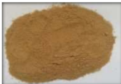
Figure IV-5 : Photographie de l'extrudât obtenu par procédé de fractionnement aqueux des graines de neem en extrudeur bi-vis de type Cleextral BC 21
