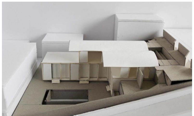
Figure 195: Photos de maquettes illustrant la transformation du toit d'une toiture plate en deux voûtes. Source : youtube.com/watch?v=QS8VTCVHy7Y
