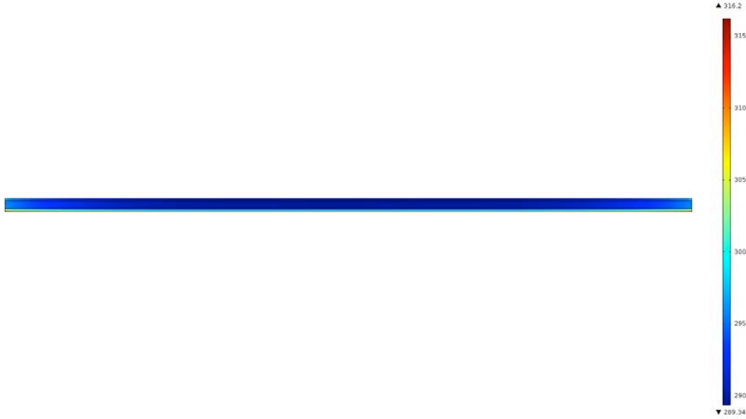
Figure 5.12 - Profil de température du composite dans la première phase de dégradation ( t = 130 s, t_0 moment d'introduction)
