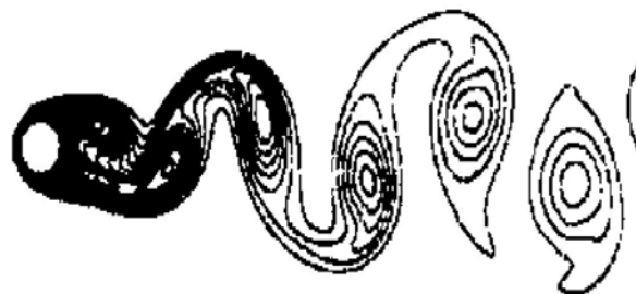
FIGURE 3.7: Iso-contours de concentration de scalaire passif obtenus par Kim & Choi (2004)
