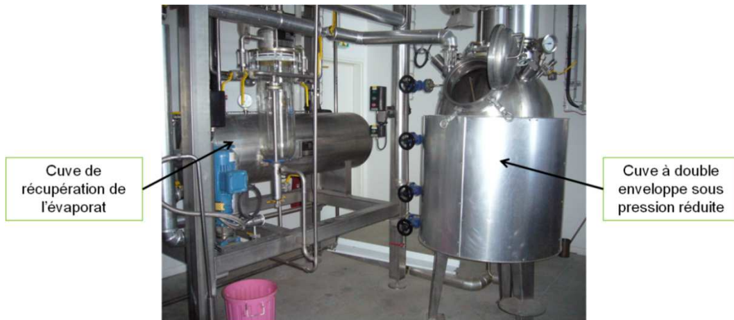
Figure 2.6 Description du dispositif expérimental d'évaporation
