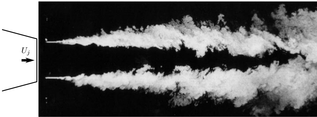
Figure I.1 – Visualisation instantanée d'une section d'un jet simple à Re = 10^5 réalisée par Parekh et al. [1988].
