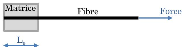
Figure V.1 : Schéma d'une éprouvette d'extraction de la fibre
