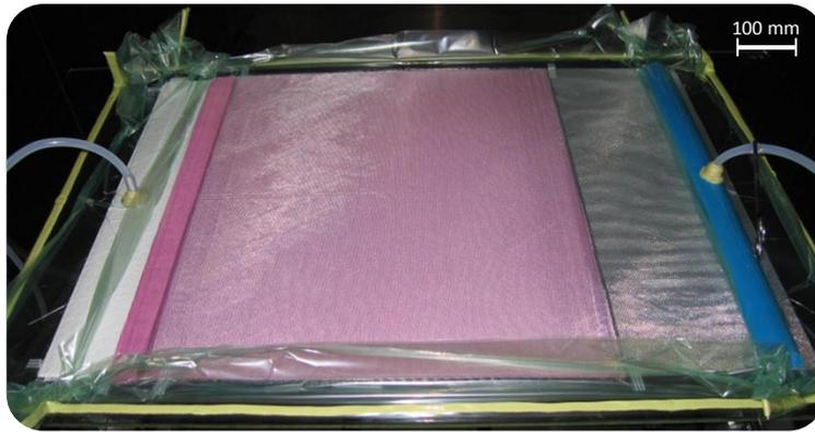
Figure II.3 : Drapage et mise sous vide
