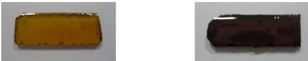
Figure III.10 : Echantillon non oxydé et oxydé
