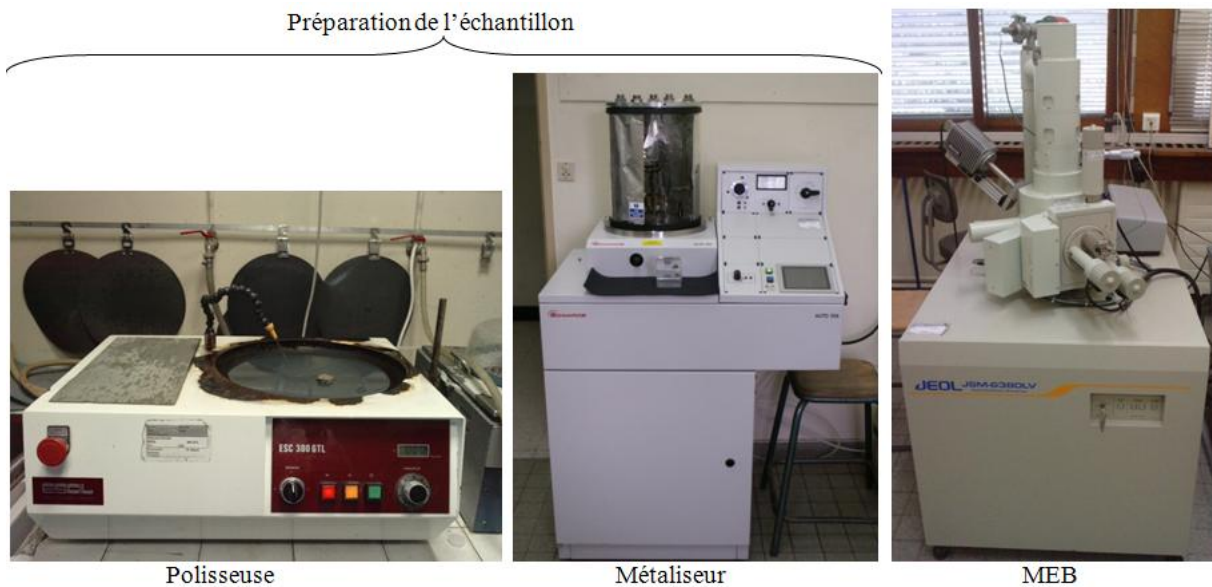
Fig.VI. 8 : Préparation de l'échantillon pour observation au MEB
