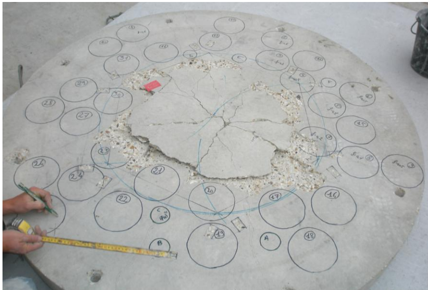
Fig.V.1 : Dalle de béton fissurée sur laquelle sont tracés les échantillons à carotter.
