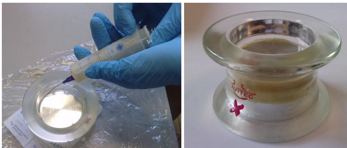
Fig.VII. 1 : Collage d'une galette dans la virole de verre et résultat (sur le test d'étanchéité, en collant une galette en aluminium).
