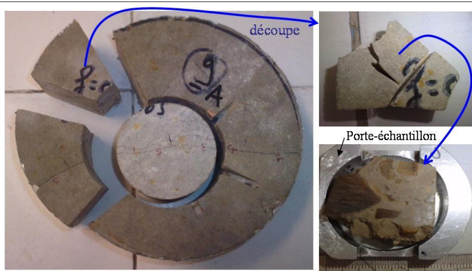
Fig.VI. 7: Découpe d'une galette pour observation au M.E.B.
