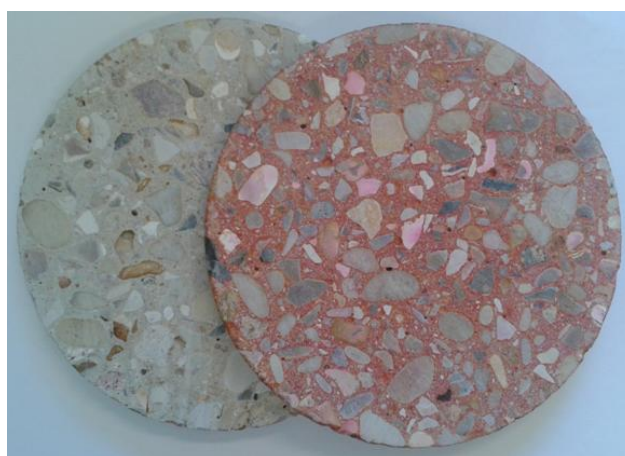
Fig.V.4 : Galette de béton brute et colorée à la rhodamine.
