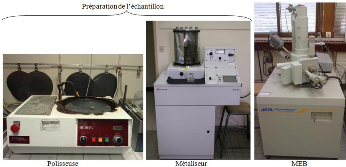
Fig.VI. 8 : Préparation de l'échantillon pour observation au MEB
