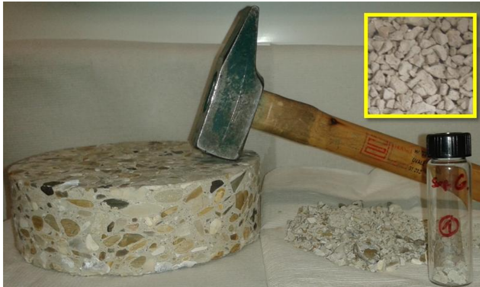
Fig.IV. 2 : Obtention de nos échantillons de « pâte de ciment » à partir du béton : concassage, et tri pour obtenir des échantillons d'environ 4mm de côté tel que dans l'encadré.
